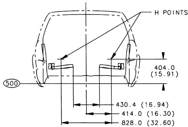
REAR VIEW SHOWING BACK JUMP SEATS FOR EXTENDED CAB
